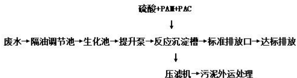
图 4.1-1 生产废水处理设施工艺图
